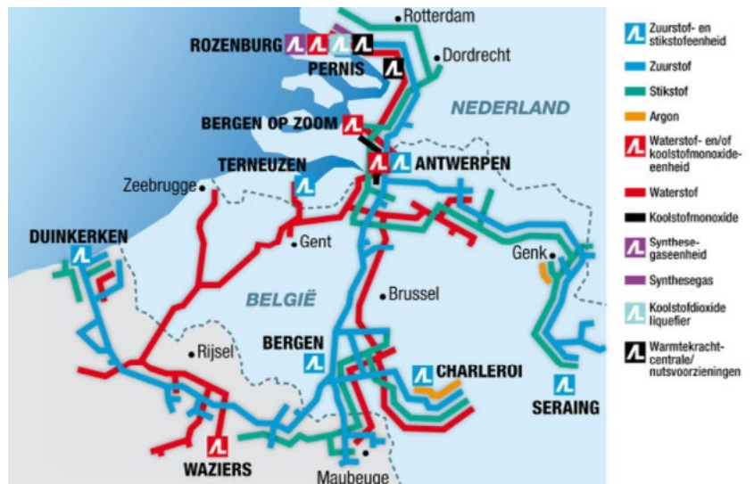
Figure 9. Réseau air liquide en Belgique 73
