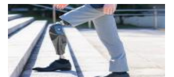
• Bio Leg, BionicM 무릎 위 절단자를 위한 로봇 의족
