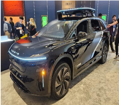
Uber - Lucid 차량: 센서 내장형 구조, Halo 디스플레이 + 통합 센서 배열
