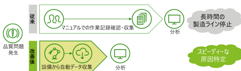
図5 品質データ自動取得による調査リードタイム短縮
