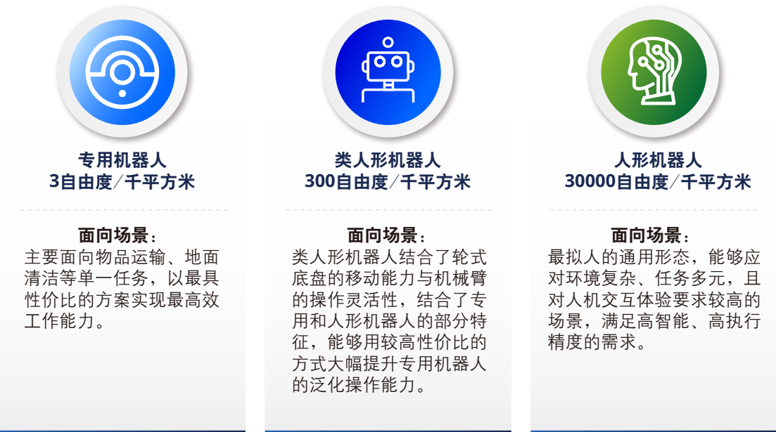
图2-7：三种形态单位工作面积内的自由度
